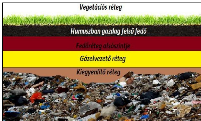
24. ábra: Bezárt települési hulladéklerakó depónia lezárásának átmeneti és végleges rétegrendje
